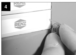
Entriegelung des Namensschildes durch Eindrücken des Entriegelungsschlüssels in die Bohrung auf der rechten Seite des Namensschildes.
