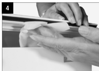
Mit einem Reinigungstuch die Klappe auf der Innenseite reinigen (entfetten).
