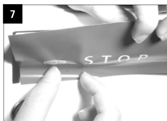
Die Folie mit der unteren Kante auf die Entnahmesicherung kleben.
