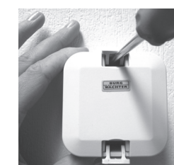
Abb. 5: Verschrauben des Transponder Extenders
