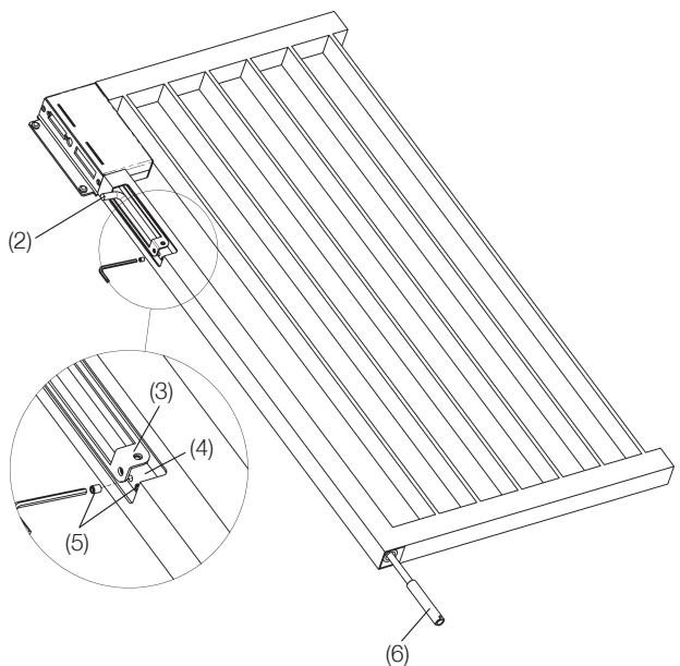
Grifftteil (2) in Halterung (3) montieren und mit Kupplungsstück (4) verschrauben. Mit Gewindestift (5) sichern. In Rohrprofil einsetzen. Ge- windestange (bauseits) mit Kupplungsstück (4) verschrauben und mit Gewindestift (5) sichern. Riegel (6) montieren.
