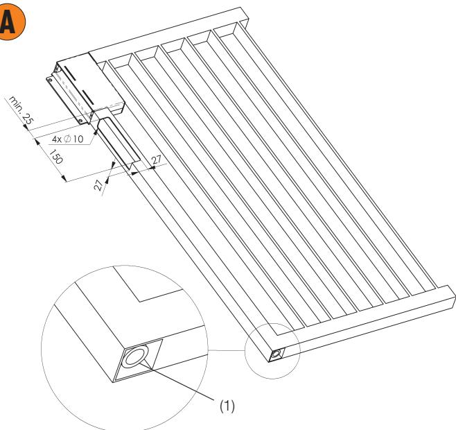
Ausschnitt mit Hilfe der Schablone in Rohrprofil einbringen.
