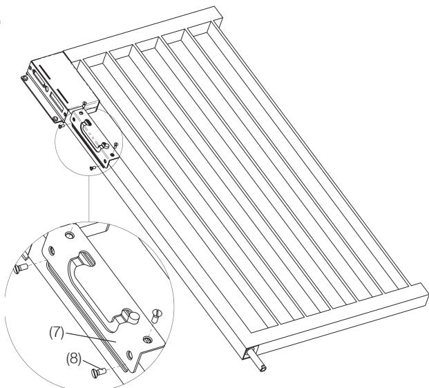
Führungskulisse (7) aufsetzen und mit Senkschrauben (8) an Halterung (3) befestigen.
